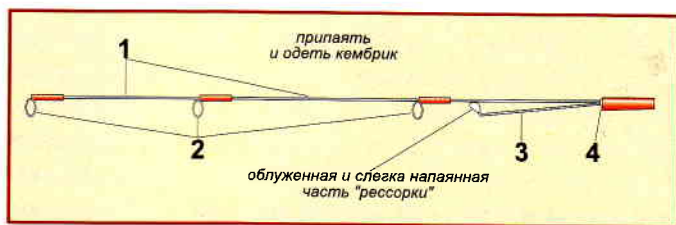
Металлический кивок для зимней ловли на течении: 1 — собственно кивок; 2 — пропускные металлические кольца; 3 — “рессорка”; 4 — спаянный участок “рессорки” и кивка, на который надет кембрик.
